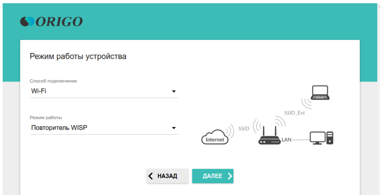
Рисунок 21. Выбор режима работы устройства. Режим Повторитель WISP .
