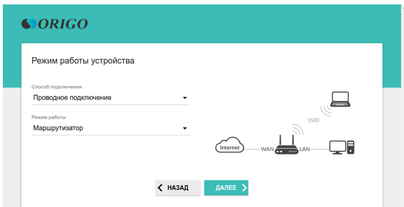
Рисунок 20. Выбор режима работы устройства. Режим Маршрутизатор .
