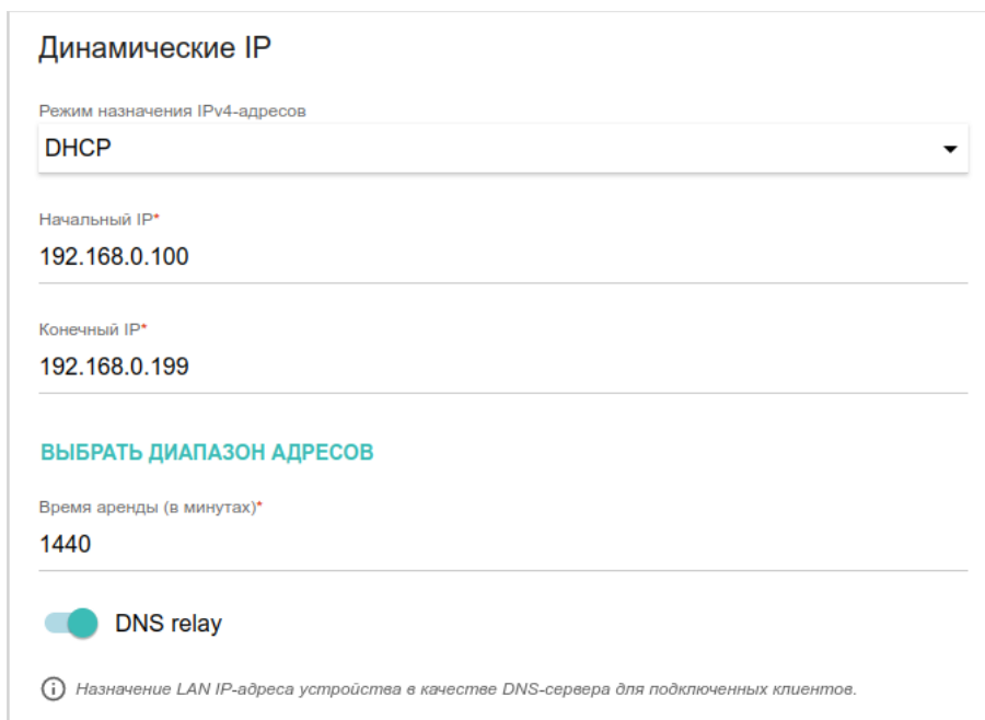
Рисунок 77. Настройка локального интерфейса. Вкладка IPv4. Раздел Динамические IP.
