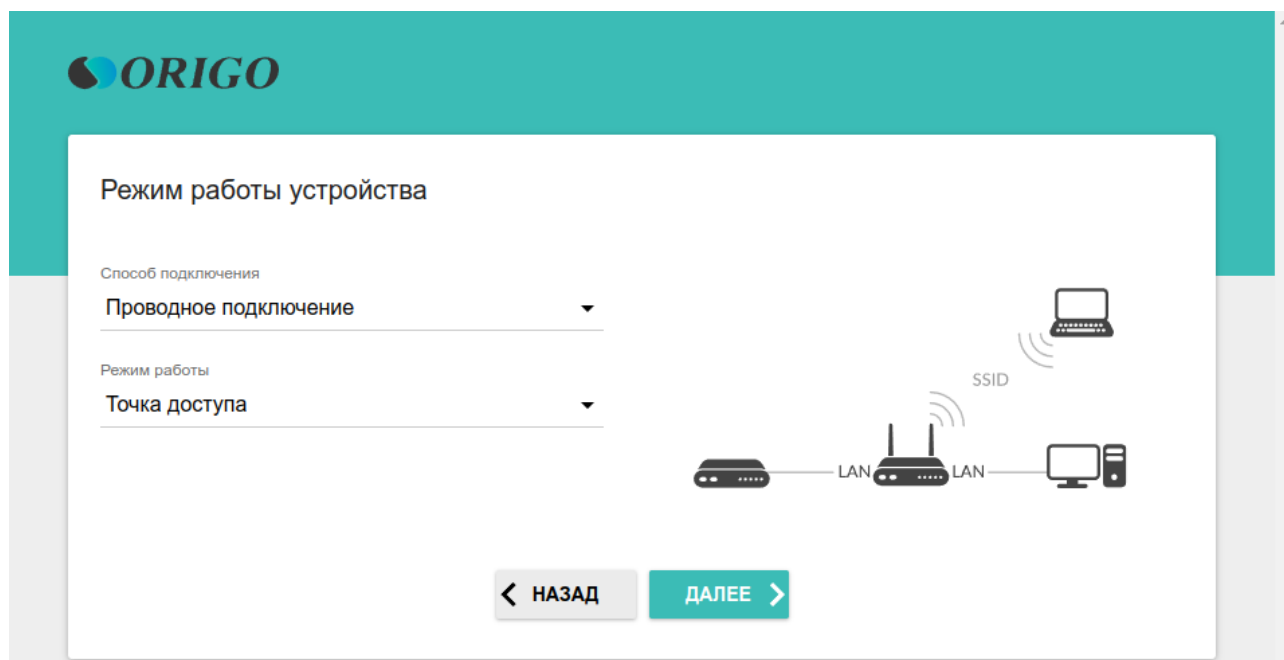
Рисунок 22. Выбор режима работы устройства. Режим Точка доступа.
