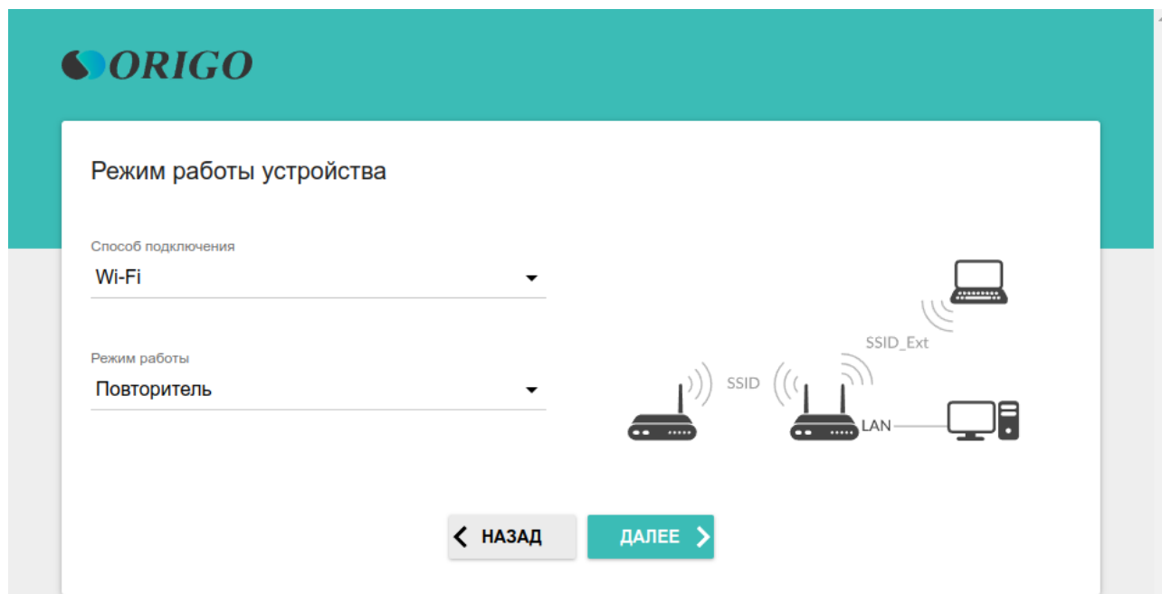
Рисунок 23. Выбор режима работы устройства. Режим Повторитель .
