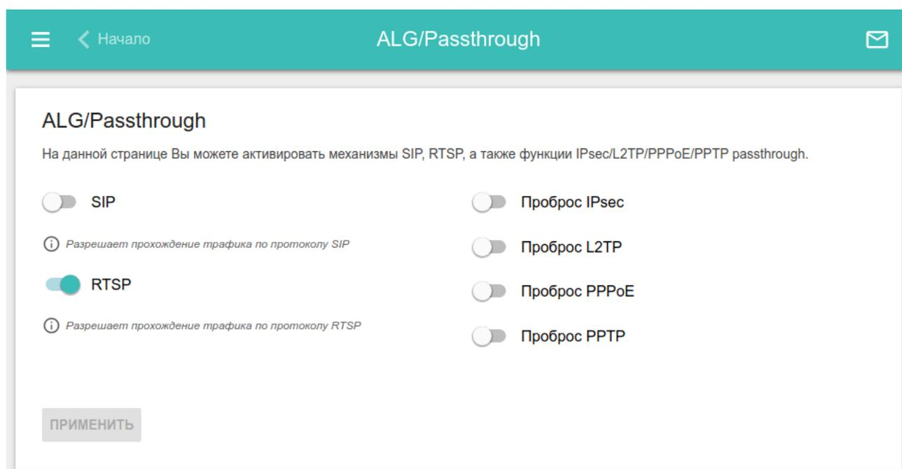
Рисунок 111. Страница **Дополнительно / ALG/Passthrough**.
