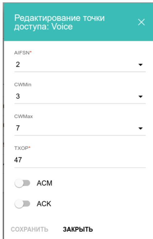
Рисунок 88. Окно для изменения параметров функции WMM.
