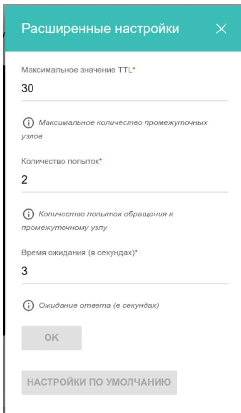
Рисунок 137. Страница Система / Трассировка маршрута. Окно дополнительных настроек.
