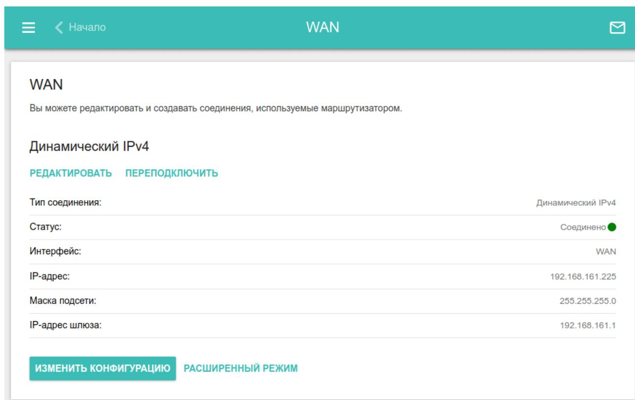
Рисунок 49. Страница **Настройка соединений / WAN**. Упрощенный режим.
