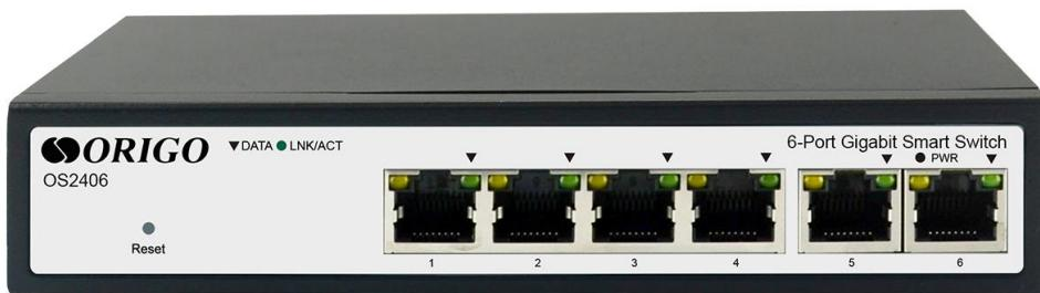
OS2406 – настраиваемый L2-коммутатор с 6 гигабитными портами RJ-45.
