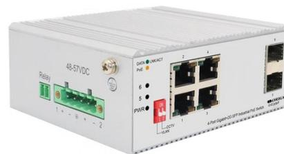
Коммутатор поддерживает стандарты 802.3af/at PoE с возможностью подачи питания до 30 Вт на порт при общем PoE-бюджете 60 Вт. Для систем видеонаблюдения реализованы режимы VLAN и CCTV, позволяющие изолировать трафик PoE-портов и увеличить дальность передачи данных и питания до 250 м.
