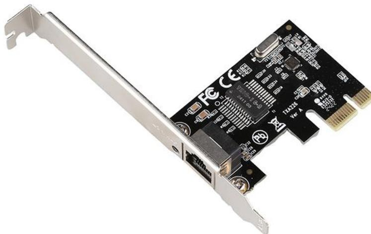
ON200 – сетевой адаптер Gigabit Ethernet для шины PCI Express.
