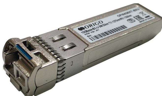
OFM436XT-BXU – двунаправленный WDM трансивер SFP+ с 1 портом 10GBase-BX-U для одномодового оптического кабеля (до 20 км).
